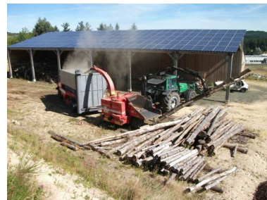
Collecte de bois, broyage sur plateforme et livraison en direct par benne à vis, ERE43
