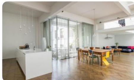
Réemploi de 290 m 2 de parquet en chêne, motif à bâton rompu, projet privé, Bruxelles (BE) © K2A architectes, Dams Craicx.
